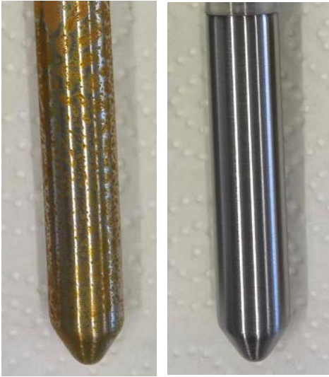
Şekil 11 Katkısız KB 95 (sol) ile ULTRAFORCE 95 Katkısı ile hazırlanmış benzin (sağ) karşılaştırmalı laboratuvar korozyon testi. 10
