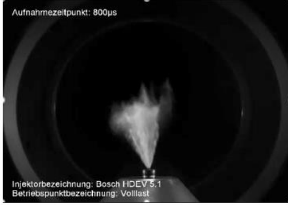
Şekil 8 Temiz ve kirli enjektörlerden yakıt püskürtülmesi. 8
